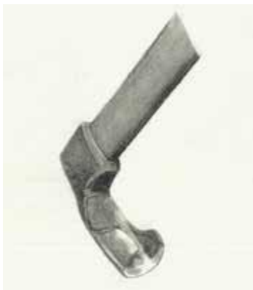
Joonis 6. Künakirves on erilise kujuga puidu õõnestamiseks (Parts, 2019 lk 194)
